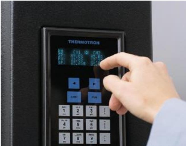
3800 編程控制器為試驗箱作環境試驗特別設計。互動式觸摸鍵區和共有 4 個顯示行、每行 20 個字元的顯示區使編程輸入和監控更加容易。3800 編程控制器可以使用 ThermoTrakII 和 DirectLink。使用 ThermoTrakII 軟體可以使多台試驗箱連接到一中央電腦，通過這台電腦可以控制多個試驗箱，這樣簡化了實驗室的管理並提高了生產率。該軟體可以應用於任何 Windows 平臺。
