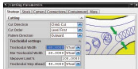
NX 的擺線切削圖樣能依據使用者定義的條件，自動避免讓您超出容許的切削條件。
