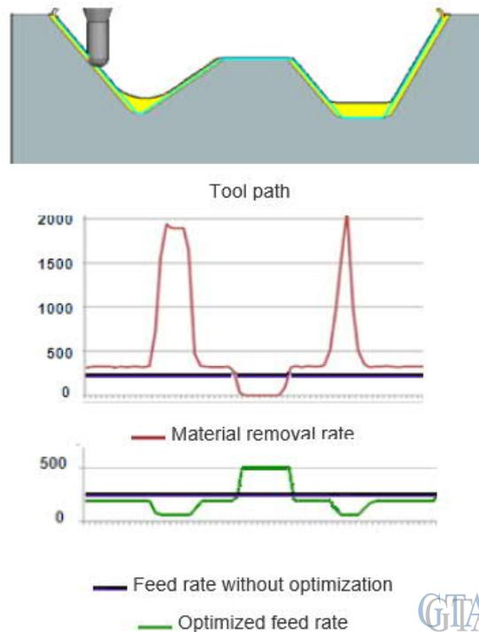
你可以在 Operation navigator 裡使用它，方法是選擇需要優化的 operation，選擇滑鼠右鍵 → Tool Path → Optimize Feed Rate.
