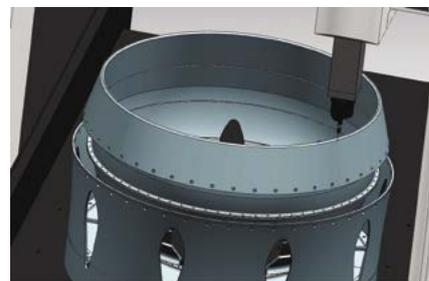
NX CMM 中使用「探頭觸點」的新高速檢查週期可在提高準確度的同時，讓檢查時間快三倍。
