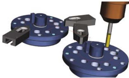
在孔群組之間最佳化鑽孔順序可確保切割安全並將進刀降至最低。
