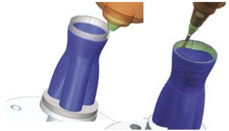
NX 混合增材製造將 3D 列印（金屬疊層）和 CNC 機械加工整合到單一環境中。
